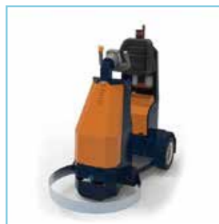
Самоходный тягач с датчиком индуктивности
