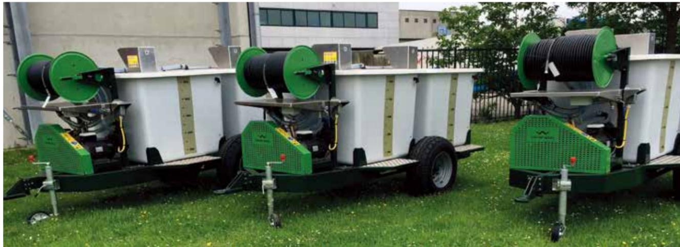
Van der Waay 泵机组小车是专门为泵送遮光剂和漫反射涂层而设计的。泵车的容量完全与您屋顶清洗机配套。泵车由耐用型材料制成，坚实耐用、可靠，可避免泵车过早磨损，延长泵车使用寿命。
