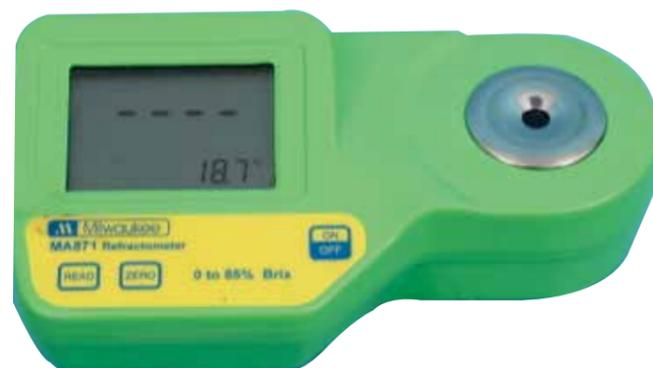
MA871 运用光学折射率原理是测量水溶液中糖的糖度，简单快捷。用去离子水或是蒸馏水校准之后测量样品，几秒钟后仪器就可以测量样品的折射率，以糖度百分比来显示结果。
