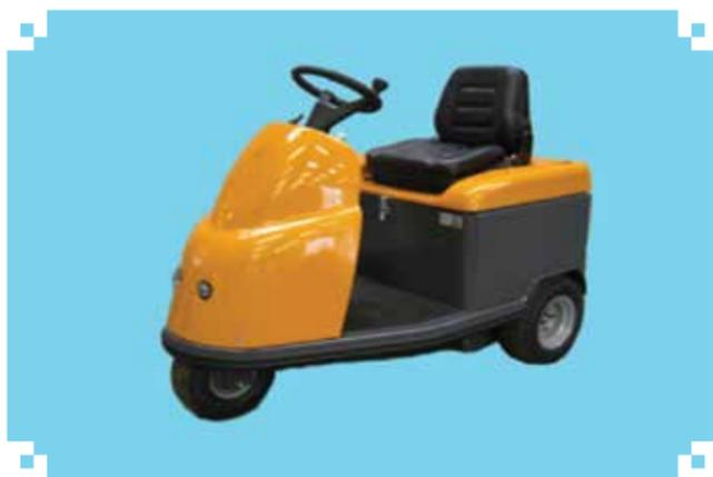
Betrac-4 电动拖车为手动驾驶型电动拖车，配备有 3.5Kw 电机，电瓶为 24V 325Ah。尺寸为 160\*95cm，旋转半径为 190cm，配备有液压式刹车，最大时速为 14km/h。车轮为黑色充气轮胎。包含 230V 50Hz，24V 30A 充电器高频充电器。
