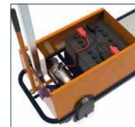
电机控制和强力牵引电瓶结合。低速运行，可长时间保持电瓶电量充足、耐用。
