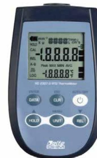
HD2307.0 是带 LCD 显示的手持式温度计，可使用浸入式、插入式、接触式、空气探头测量温度。传感器可以是 3 线制或 4 线制 Pt100 和 2 线制 Pt1000。所有型号的探头都带有智能检测模块，且出厂校准的数据已经存储在模块中。
